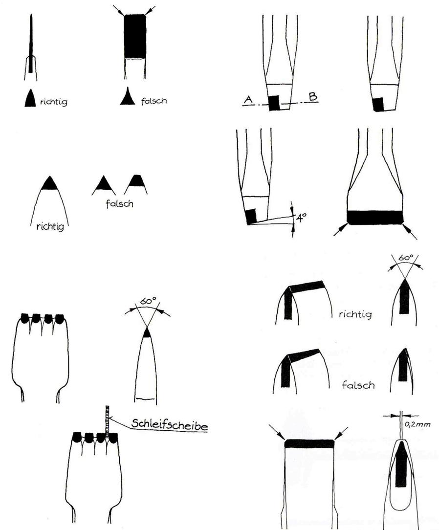
Abbildungen mit wichtigen Hinweisen, für das Anschleifen von Werkzeug mit Hartmetalleinsätzen.
