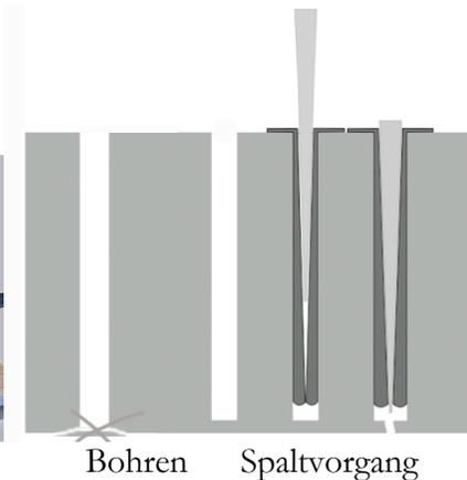
Die Genauigkeit einer Spaltung ist vom Steingefüge, der Lagerrichtung und vom Abstand der Bohrlöcher abhängig. Die Löcher müssen im Minimum den doppelten Lochdurchmesser Abstand voneinander haben und parallel zueinander verlaufen. Ein Ineinanderlaufen der Bohrungen ist unbedingt zu vermeiden. Beim Cristallina-Marmor hat sich ein Lochabstand von 8 – 10 cm bewährt.
