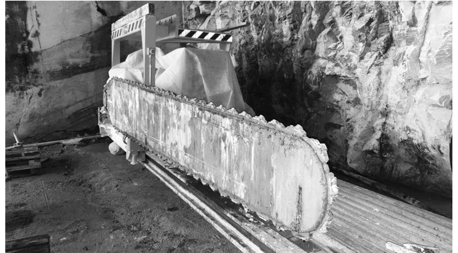
Schrämen ist eine wirtschaftliche und schonungsvolle, der Holzgewinnung verwandte Abbautechnik. Die wassergekühlte, diamantbestückte Kettensäge, mit einer Lanze von mehreren Metern Länge, wird dabei in den Stein getrieben.
