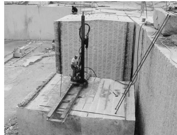
Bohrtechnik in einem Granitsteinbruch.
