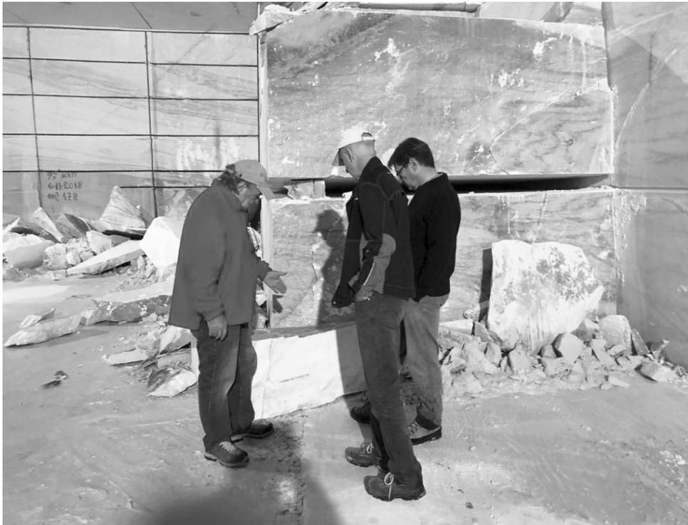
Untertag-Abbau findet unabhängig von der Witterung statt. Die zusätzliche Abbau-Richtung - bergwärts - ermöglicht eine präzisere Materialwahl und eine höhere Ausbeute (%-Anteil fertige Blöcke/Abfall).
