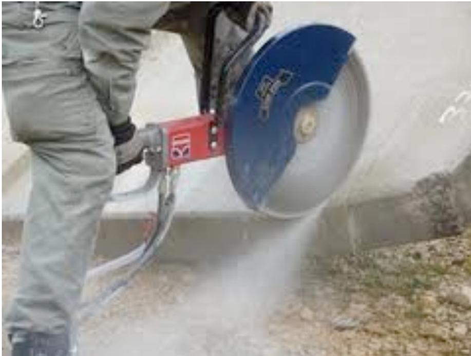
Um die Zweckmäßigkeit von nichtindustriellem Maschinen-Einsatz bei der Steinbearbeitung beurteilen zu können, bedingt es genaue Kenntnis der Möglichkeiten aber auch der Grenzen der Geräte. Grundsätzlich gibt es zwei verschiedene Systeme: Druckluftgeräte und elektrisch betriebene Hand-Maschinen. Druckluftgeräte sind in der Regel lauter, aber handlicher als elektrische.
