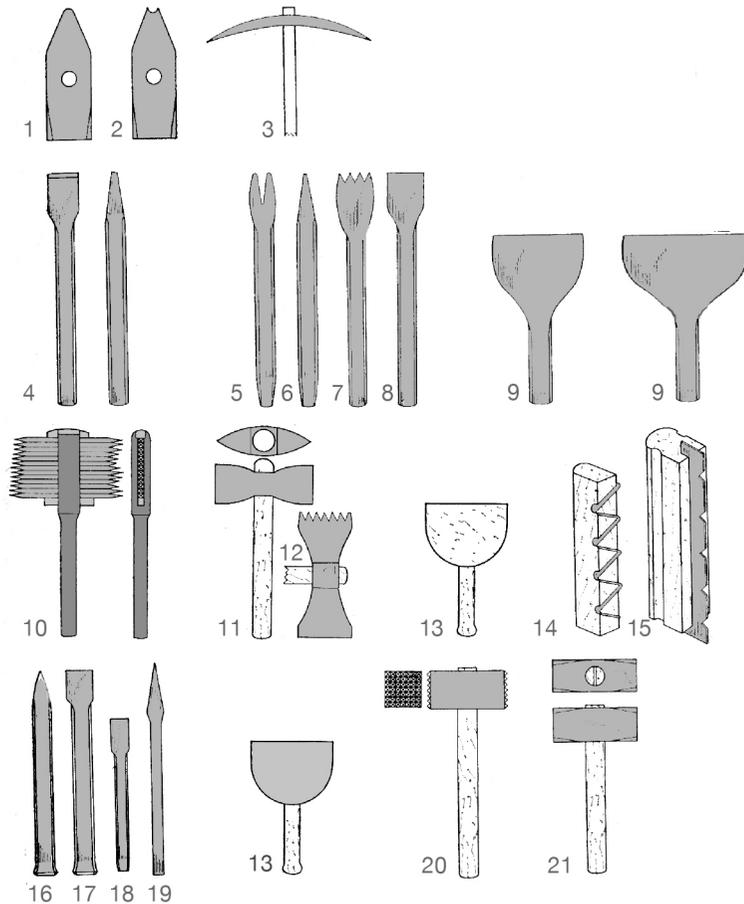
1. Kopf eines Finnhammers, zum seitlichen Anschlagen beim Spalten
