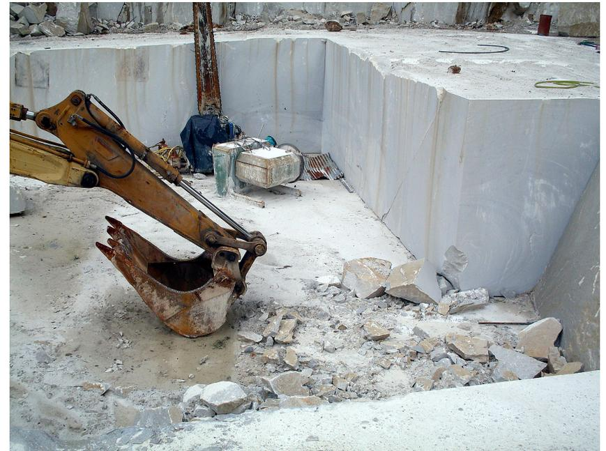
Diamantseilschnitt-Technik im Cristallina-Bruch.
