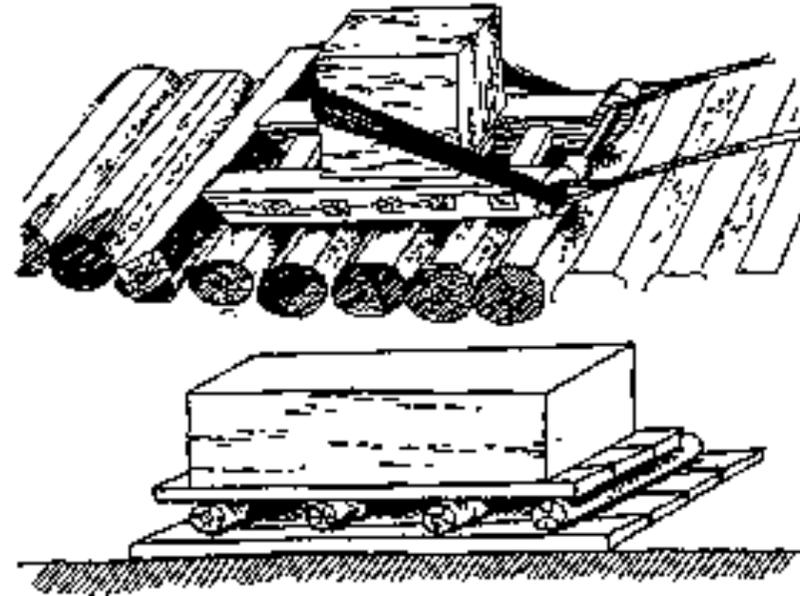
Auch mit einfachen Hilfsmitteln, wie Lochwalzen, Stemmeisen, Drehunterlagen und Kanthölzern lassen sich mehrere Tonnen schwere Steine mit relativ geringem Kraftaufwand bewegen und in für die Bearbeitung praktische Positionen hieven.
