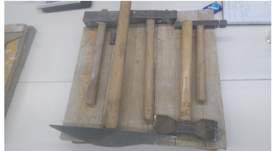
Der heute für die Herstellung von Stein-Handwerkzeug verwendete Rohstoff enthält neben Eisen Kohlenstoff, Silizium und Mangan. Das Härten erfolgt am fertig geformten Eisenwerkzeug durch geschicktes Erwärmen und Abkühlen in Öl oder Wasser.
